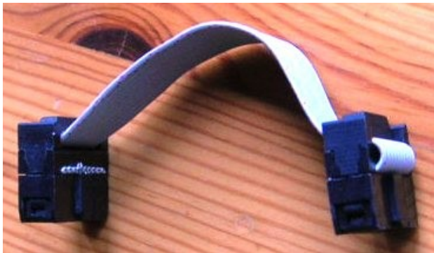
Figura 21: Cavo per la connessione di periferiche esterne a montaggio ultimato
