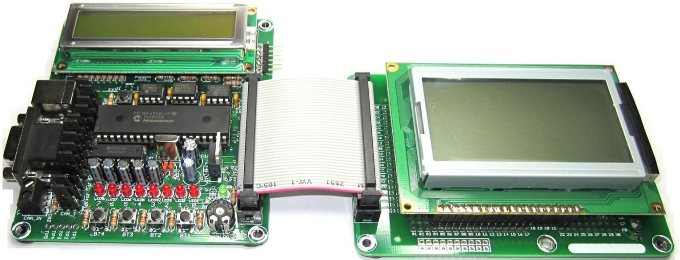
**Figura 6:** Connessione della scheda di espansione a Freedom II (esperimento con GLCD).
