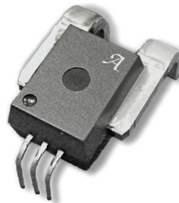
Figura 6: Esempio sensore Hall ACS758LCB (estratto del datasheet).
