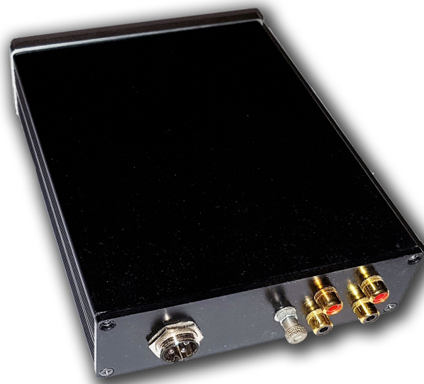
Figura 7: Posizionamento dei connettori RCA.
