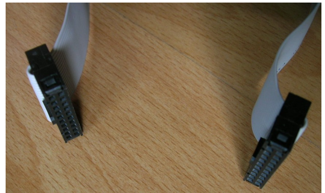
Figura 4: Cavo per la connessione della scheda al sistema a montaggio ultimato
