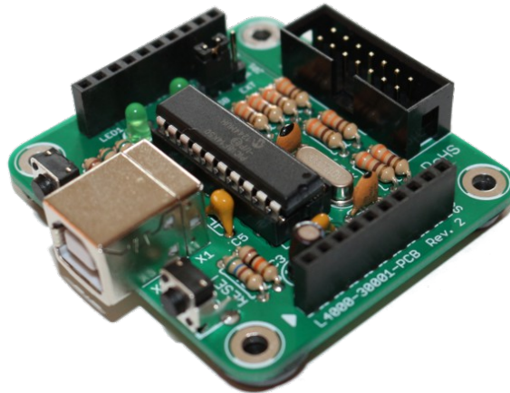
Figura 13: Scheda miniCOM USB a montaggio ultimato con connettore tipo B.
