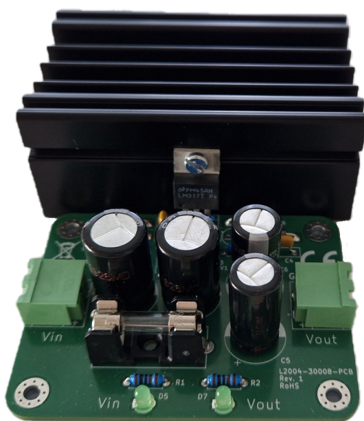
Figura 15: Sistema a montaggio ultimato con aletta di raffreddamento.
