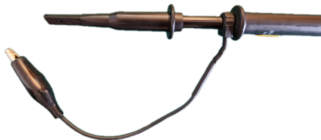
Figura 7: Sonda dell'oscilloscopio con collegamento classico di massa (coccodrillo).
