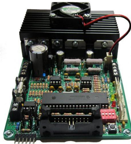
Figura 20: Scheda controllo motori a montaggio ultimato.
