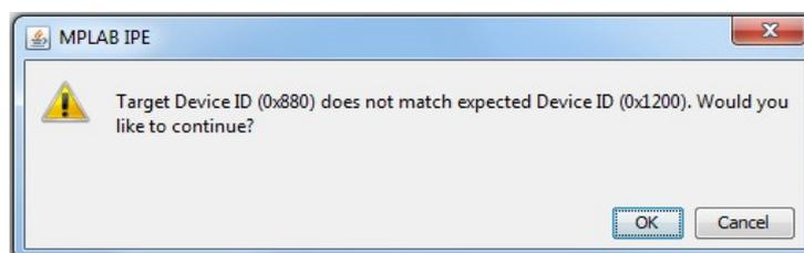
**Figura 11:** Messaggio di errore nel caso in cui il PIC montato e quello selezionato differiscano.
