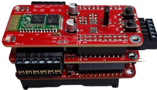
**Figura 12:** Esempio di schede multiple assemblate – PIC32, PLC e Bluetooth.
