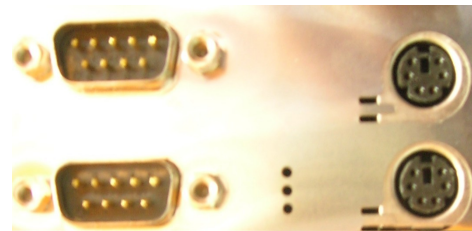
Figura 1: Porte seriali sul retro del PC
