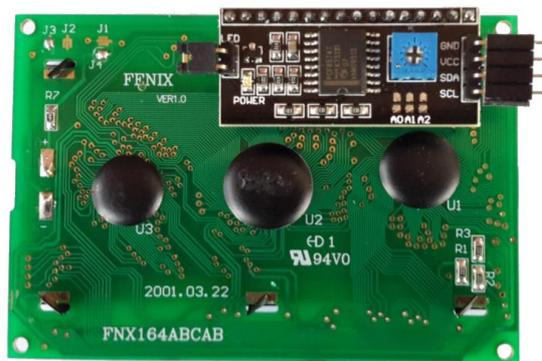
Figura 10: Dettaglio della scheda per convertire il protocollo I2C in Parallelo, collegata al modulo LCD.
