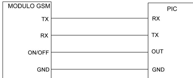
**Figura 6:** Schema a blocchi per il collegamento del modulo e il microcontrollore.
