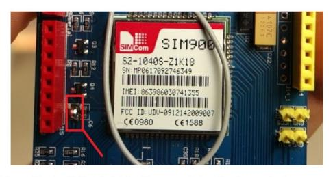
2) Collegare D9 sullo shield al pin Arduino D9 come mostrato nello schema qui sotto.
